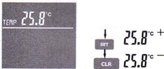
Относительная влажность материала зависит от его температуры. Влагомер автоматически компенсирует температуру материала путем измерения температуры окружающего воздуха. Этот показатель используется в расчетах влажности материала.
