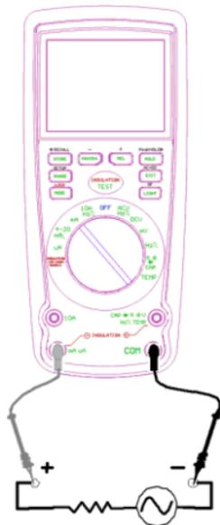
9. Проверить показания на экране прибора. В диапазоне измерений 10A показания частоты выводятся на дополнительный экран с правой стороны.
