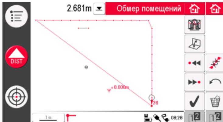
14. При выборе **Да**: появляется новая панель инструментов, например для определения недостающих точек с помощью функции DIST или удаления ненужных точек клавишей с символом корзины.
