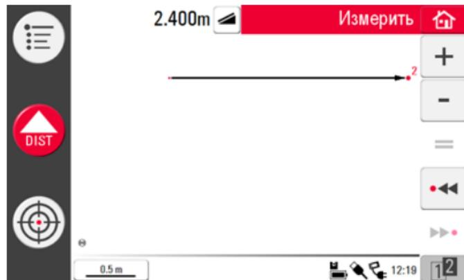
6. После измерения третьей точки она соединяется с первой точкой предлагаемой линией. Выбранная линия всегда отображается более жирной со стрелкой в направлении измерения.
