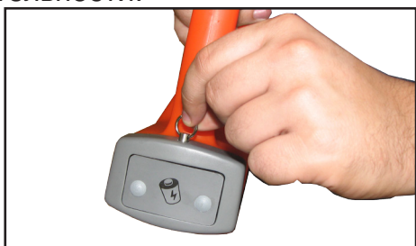
а) Выдвинуть фиксатор освободить батарейный отсек
