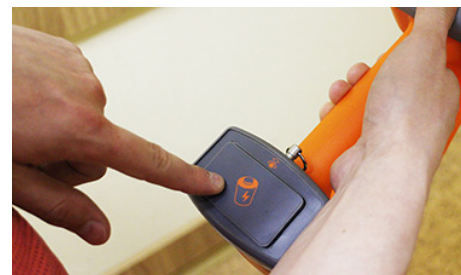
в) Установить батарейный отсек в корпус до щелчка
