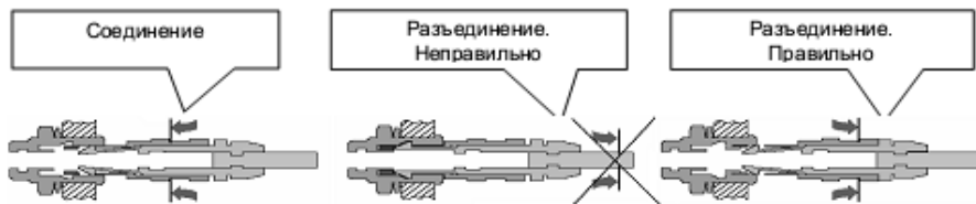
(Рисунок 6.2.). Манипулирование разъемами LEMO
