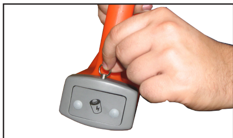
а) Выдвинуть фиксатор освободить батарейный отсек
