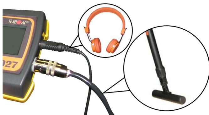
2.1 Привести электромагнитный датчик из транспортного в рабочее положение. Для этого: ослабить стопорную гайку (1), раздвинуть штангу (2) до требуемого размера и зафиксировать стопорной гайкой.
