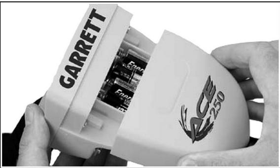
Для для установки или замены батарей осторожно сдвиньте крышку с блока управления.
