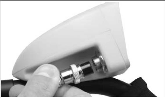
Вставьте штекер кабеля в разъем блока управления и заверните фиксирующее кольцо вручную, не прилагая усилий.
