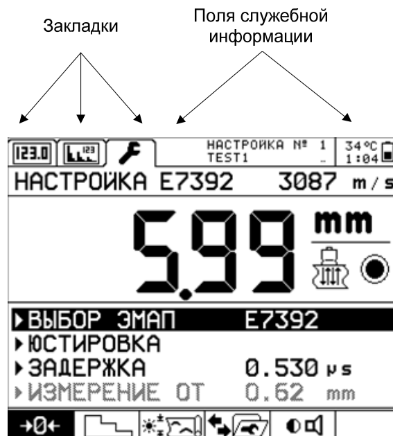
Рисунок 8 - Изображение экрана в режиме НАСТРОЙКА
