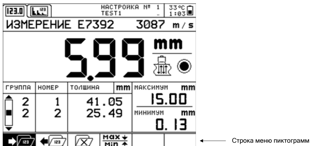
Рисунок 10 - Внешний вид экрана в режиме ИЗМЕРЕНИЕ
