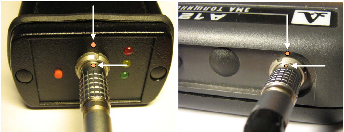
Рисунок 20 - Ориентация разъемов при подключении зарядно-питающего устройства
