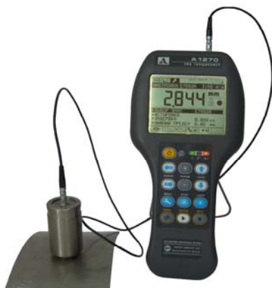
Рисунок 7 - Использование жесткой подставки
