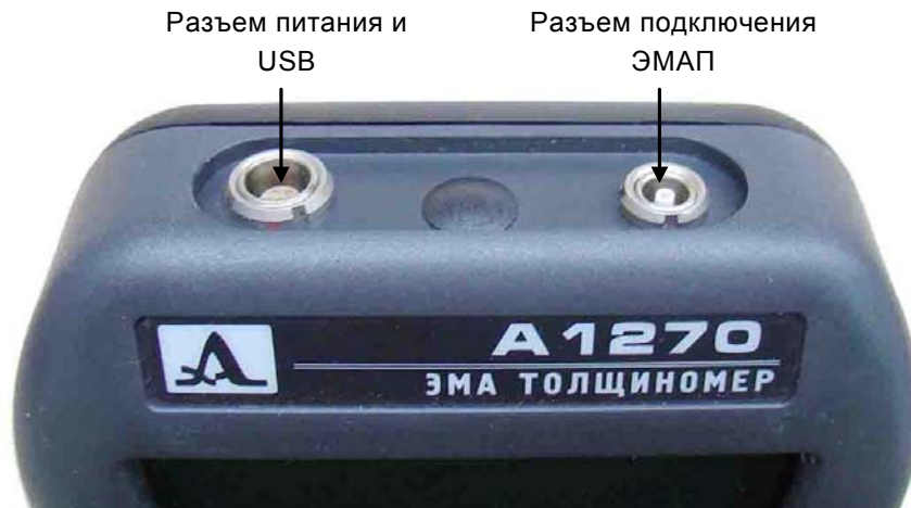
Рисунок 2 - Разъемы электронного блока толщиномера
